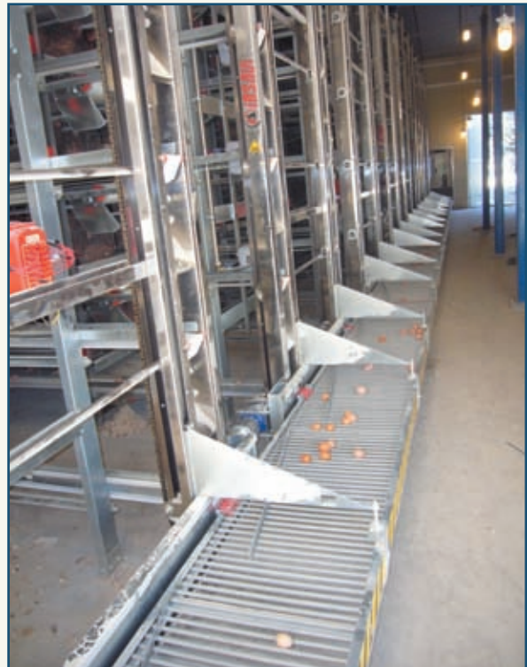
Sistema de recogida de huevos por ascensor, con cabezales de acero inoxidable y transportador y con posibilidad de curva.
